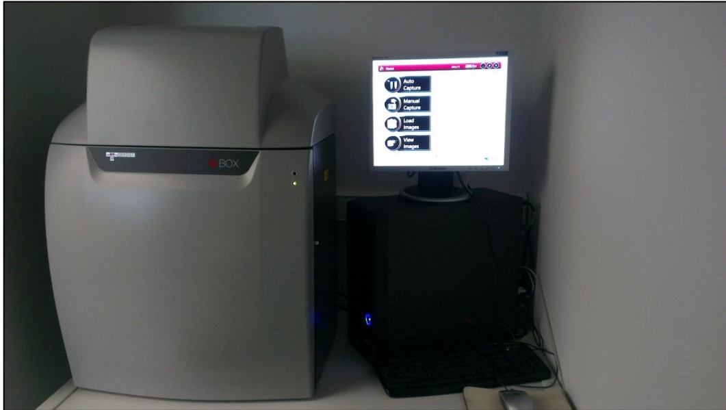
Slika 8. Uređaj za snimanje gela - G:BOX F3 (foto original; S. Guberac)
