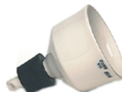
Slika 22. Büchnerov lijevak s gumenim čepom.
