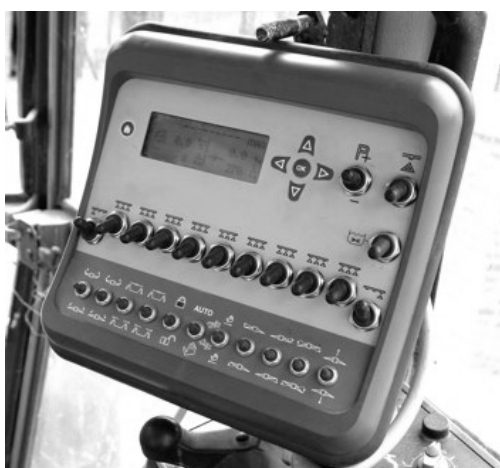
Slika 2. Digitalni uređaj za kontrolu ispravnosti rada prskalice Figure 2. Device for accuracy control of sprayer running
