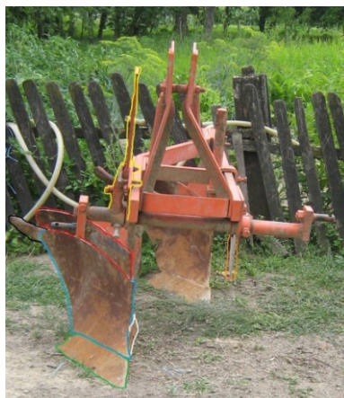
Slika 3. Naznačeni dijelovi pluga (foto: Z. Gugić, 2010 god.)
