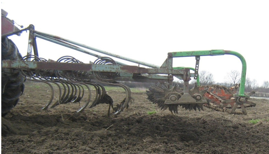
Slika 4. Prikaz sjetvospremača (foto: Z. Gugić, 2015.)
