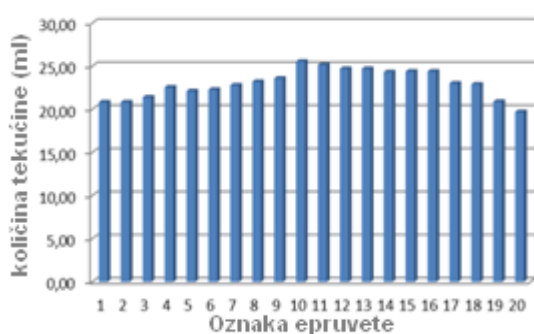
Grafikon 3. Preklapanje mlazova pri radnom tlaku 2 bar i radnoj visini 60 cm
