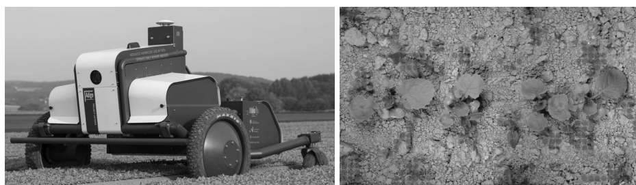
Slika 8. Robot Asterix (lijevo) i razlikovanje korova i usjeva (desno) (Izvor: https://www.asterixproject.tech )
