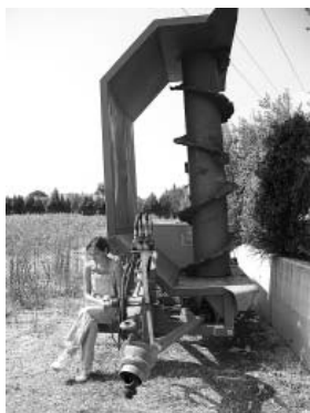
Slika 2. Strojevi za okretanje kompostne hrpe (foto: M. Stojnović i M. Vukobratović)
