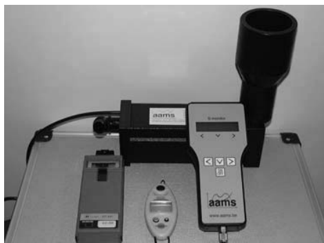
Slika 3. Uređaji za mjerenje protoka mlaznica
