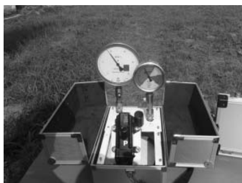
Slika 2. Komparator tlaka Volos
