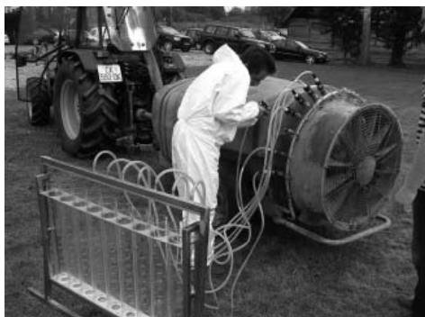
Slika 3. Uređaji za mjerenje protoka mlaznica
