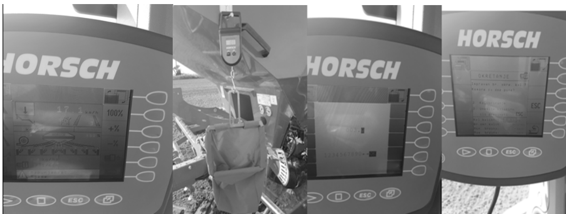
Slika 3.a. Zaslone računala sijačice Horsch Pronto 6 DC, 3b. Kalibracija sjemena (Izvor: Šarić, 2016.)
