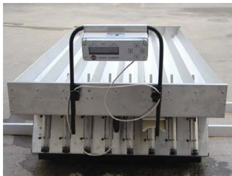
Slika 4. Ispitivanje površinske raspodjele tekućine kod nošene ratarske prskalice
