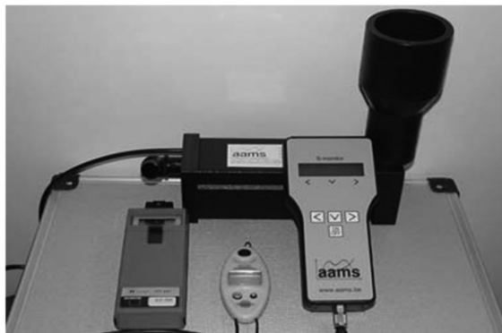
Slika 4. Elektronski mjerač protoka mlaznica belgijske tvrtke AAMS
