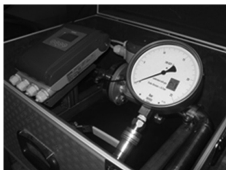
Slika 1. Elektromagnetni mjerjač kapaciteta crpke tvrtke Krohne
