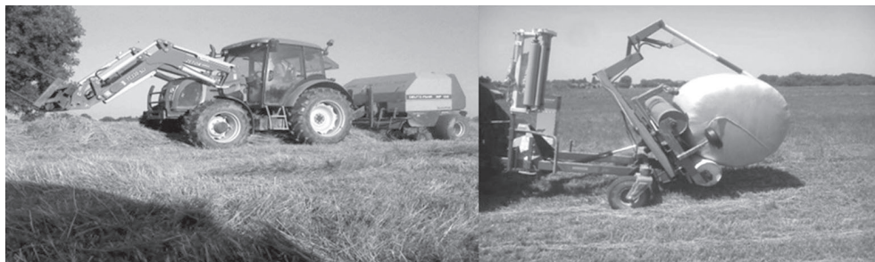
Slika 3: Preša i omotač za valjčaste bale (Foto: Crnković)
