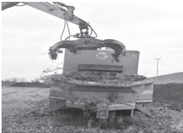
Slika 2. Ubacivanje otpada na transportnu traku korištenjem grajfera
