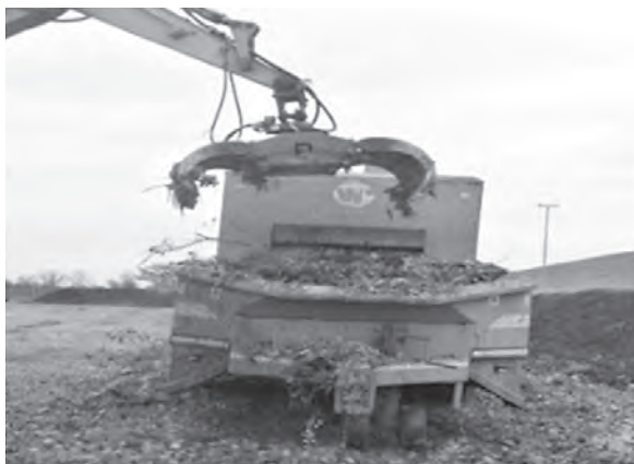
Slika 2. Ubacivanje otpada na transportnu traku korištenjem grajfera
