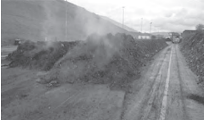
Slika 3. Kompostne hrpe-trake duljine 100 m
