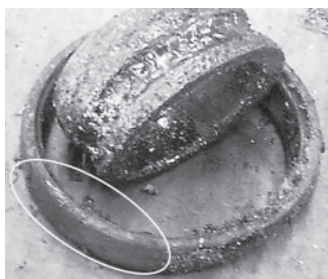
Slika 11. Tribokorozijsko trošenje vanjskog prstena ležaja (Đurkić, 2018.)
