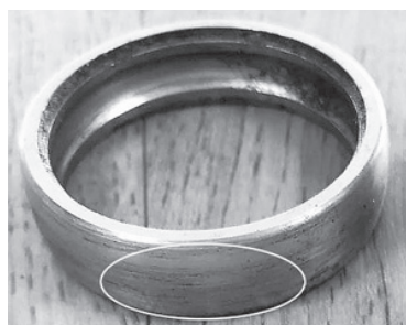
Slika 7. Abrazijsko trošenje vanjskog prstena ležaja (Đurkić, 2018)
