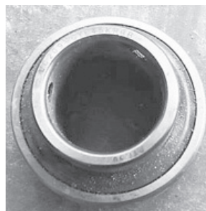
Slika 6. Očišćeni Y-ležaj (Đurkić, 2018.)
