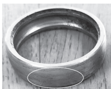
Slika 7. Abrazijsko trošenje vanjskog prstena ležaja (Đurkić, 2018)
