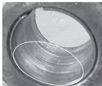
Slika 8. Abrazijsko trošenje unutarnjeg prstena ležaja (Đurkić, 2018.)(Đurkić, 2018.)
