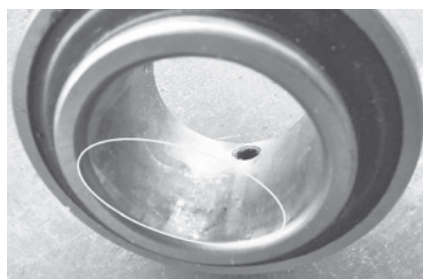
Slika 12. Tribokorozijsko trošenje unutarnjeg prstena ležaja (Đurkić, 2018.)
