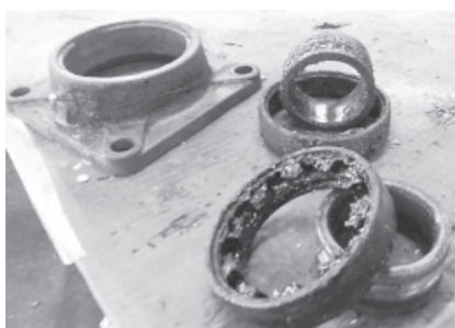
Slika 5. Demontirani Y-ležaj (Đurkić, 2018.)
