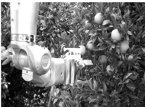
Slike 3. – 4. Robot Demeter (lijevo); robotska ruka pri ubiranju (desno)
