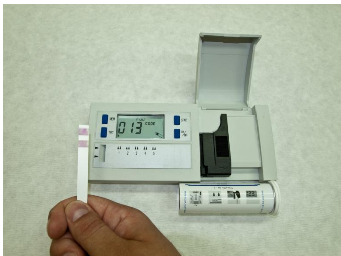
Slika 11.10. Mjerenje koncentracije nitrata mobilnim aparatom Reflectoquant
