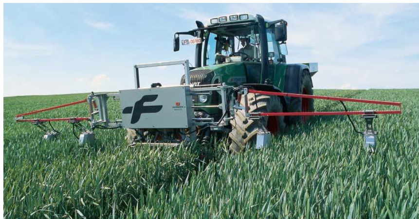
Slika 11.29. Mjerenje fluorescencije laserskim uređajem MiniVeg N (Fritzmeier Umwelttechnik GmbH & Co. KG)
