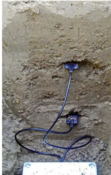
Slika 16. Mjerenje temp. i vlage tla
