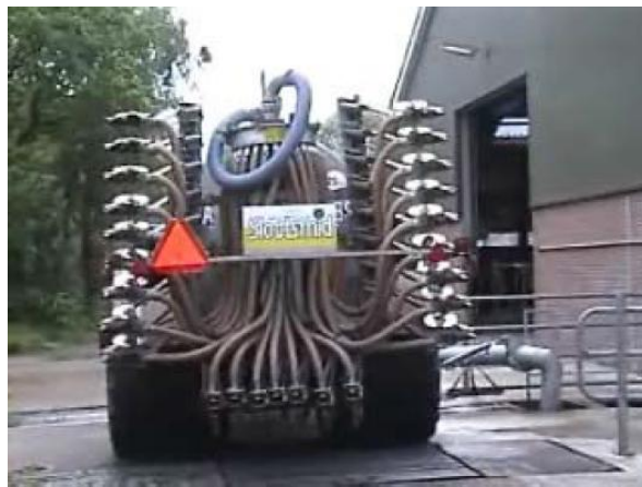
Slika 18. Uporabom ulagača (injektora) neugodni miris smanjuje se od 55-85% (Katalinić i sur., 2009.)
