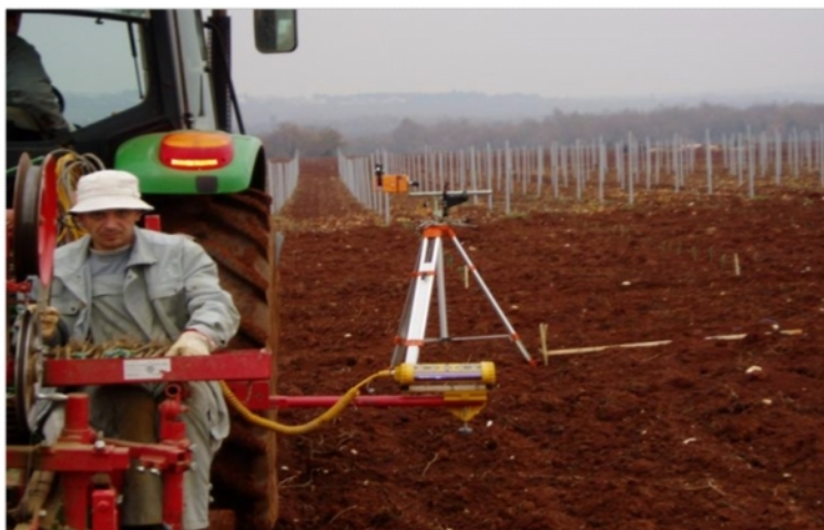
Slika 14. Sustav za navo enje laserom (Izvor: Prekalj, 2013.)
