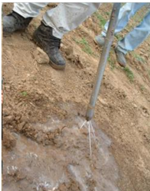
Slika 5. Prikaz hidrobura (Izvor: Prekalj, 2013.)
