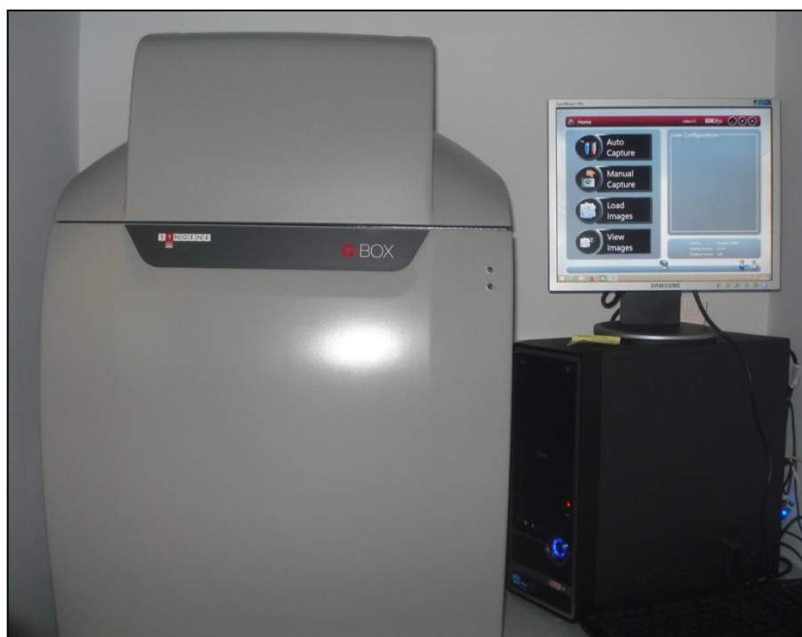
Slika 10. G:Box uređaj za snimanje gela nakon elektroforeze
