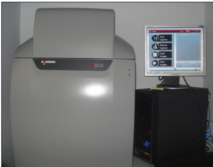
Slika 10. G:Box uređaj za snimanje gela nakon elektroforeze
