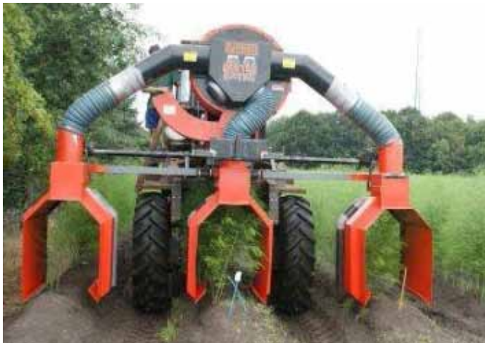
Slika 1. Pneumatski sustav prikupljanja štetnika (Izvor: www.plantenziektekunde.nl )
