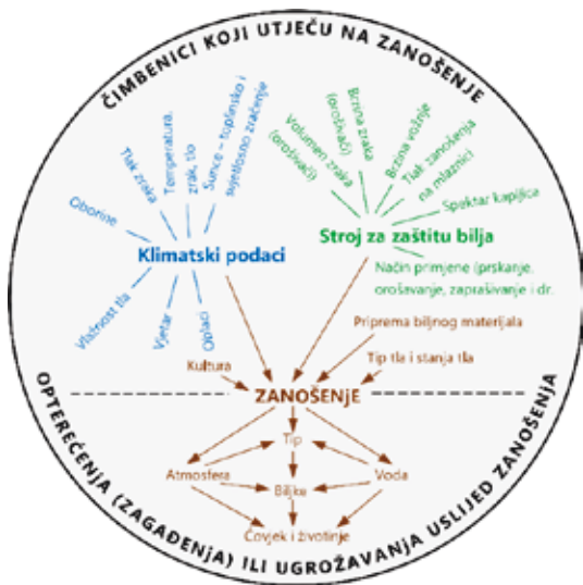
Slika 4. Čimbenici koji utječu na zanošenje tekućine i njezin utjecaj na okoliš (Izvor: Hosseinipour)
