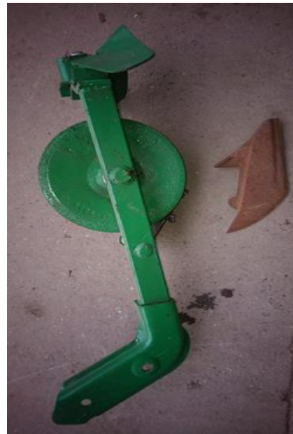
Slika 15. Oprema za sjetvu repe i povrća – kopirni kotač s odstranjivačem gruda i raončić
