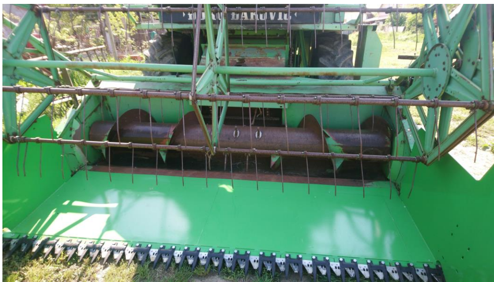
Slika 20. Žetveni uređaj kombajna za ubiranje uljane repice
