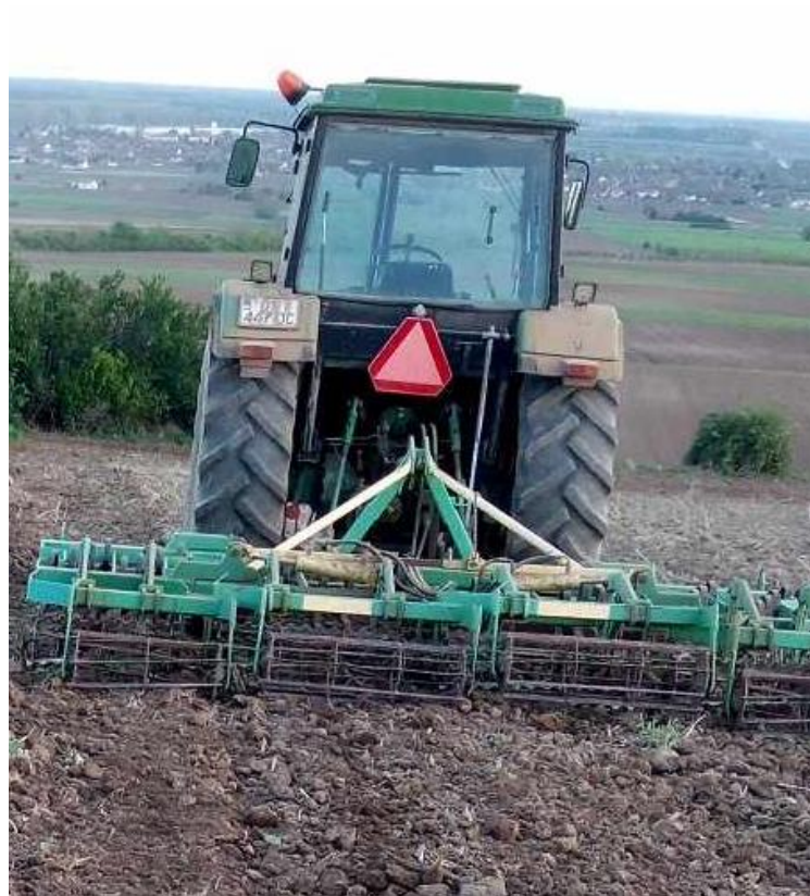
Slika 12. Traktor John Deere i sjetvospremač FPM Dubica 3,6 m
