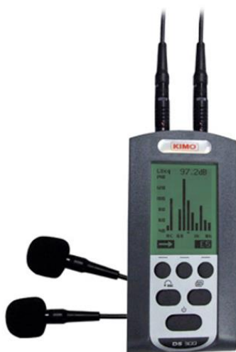
Slika 7 Kimo DS 300 dozimetar za mjerenje buke.
