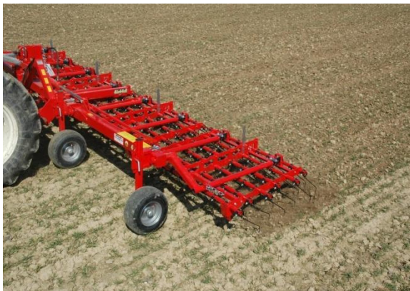
Slika 3. Mehaničko suzbijanje korova u šećernoj repi (Foto: Meretine d.o.o)
