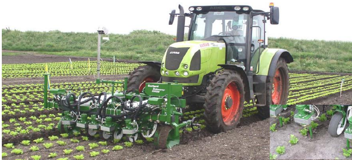
Slika 9. RoboCrop – međuredni sustav za suzbijanje korova (Foto: L. Dunwell)
