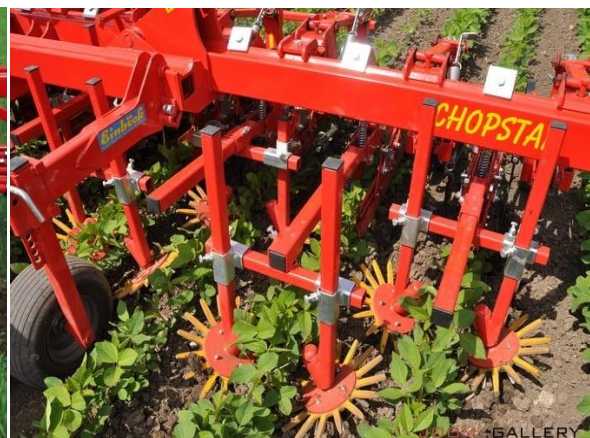
Slika 6. Mehaničko suzbijanje korova u soji (Foto: Meretine d.o.o)
