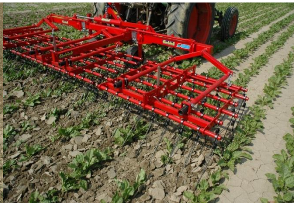
Slika 4. Mehaničko suzbijanje korova u šećernoj repi (Foto: Meretine d.o.o)
