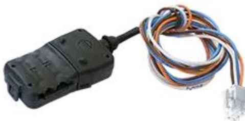
Slika 22. Beskontaktni čitač podataka (Izvor: https://technoton-telematics.com )
