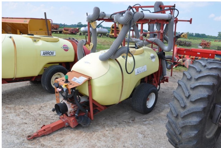
Slika 6. Sustav istrujavanja zraka (Hardi Arrow)
