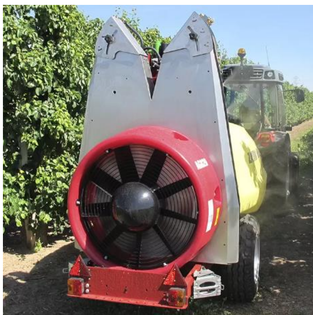
Slika 5. Sustav istrujavanja zraka, raspršivač s aksijalnim ventilatorom (Hardi Zaturm)
