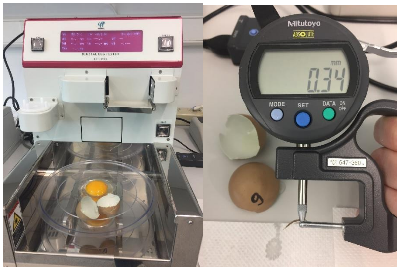
Slika 6. Automatskim uređajem Digital Egg Tester - DET 6500 (Nabel,Co., Ltd, Japan)
