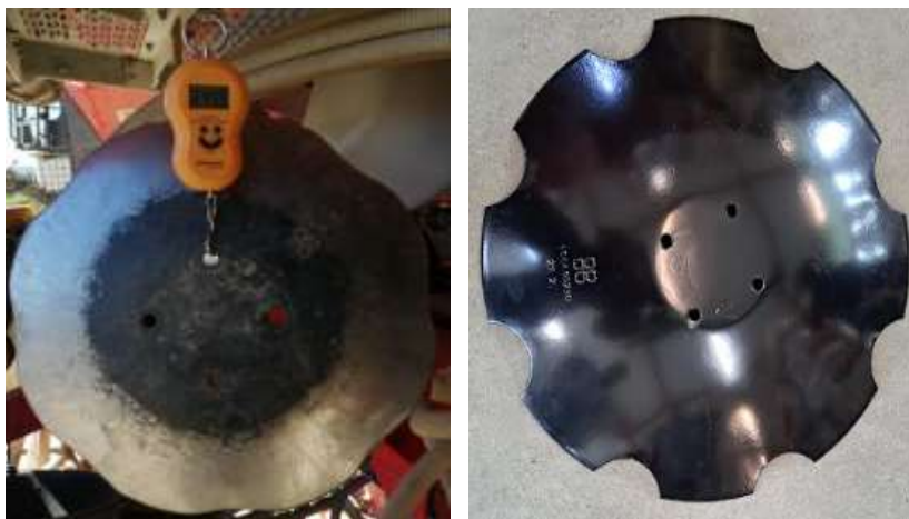
Slika 31. Usporedba istrošenog i novog diska
