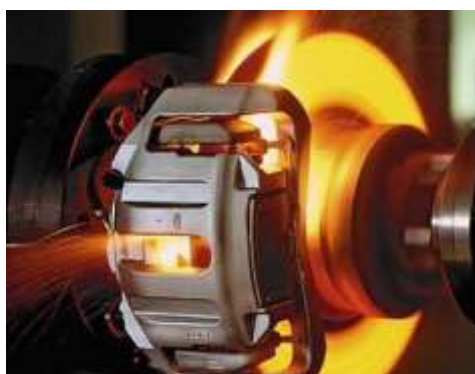
Slika 8. Prekomjerno zagrijavanje kao nuspojava trenja
