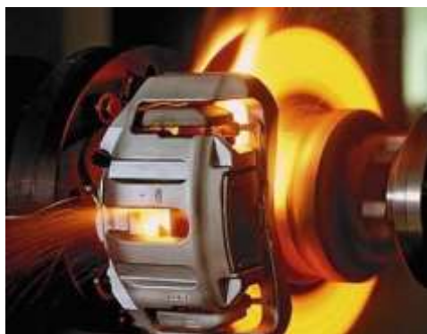
Slika 8. Prekomjerno zagrijavanje kao nuspojava trenja
