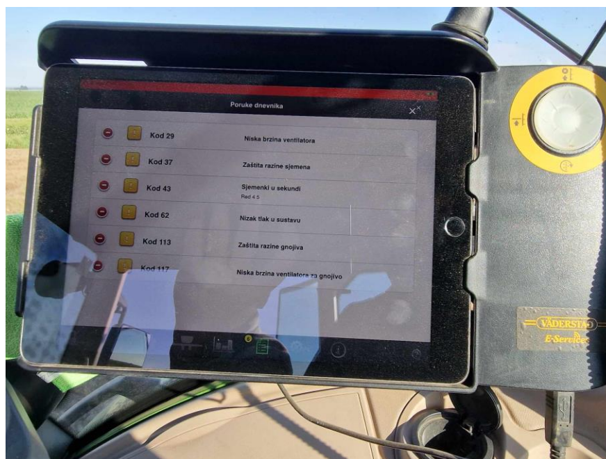
Slika 18: kodovi pogrešaka na sijačici
