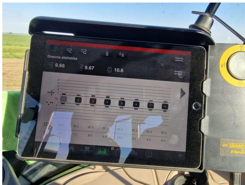
Slika 20: prikaz norme sjemena po sjetvenoj jedinici
