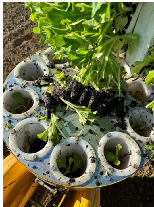
Slika 12. Ubacivanje duhanskih presadnica u bubanj za sadnju (Dikšić, M., 2020.)
