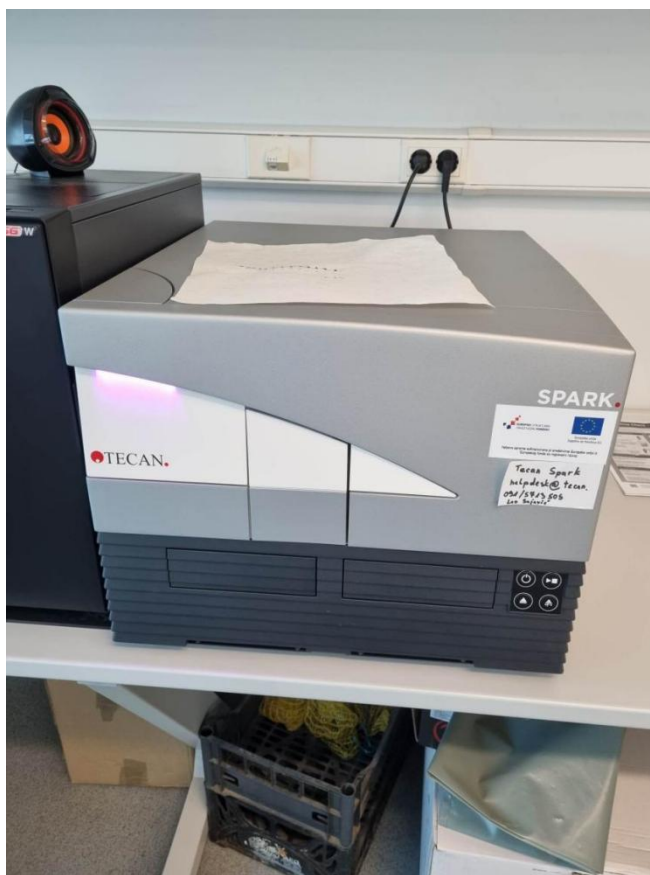
Slika 2. Čitač mikrotitarskih pločica Tecan Spark
