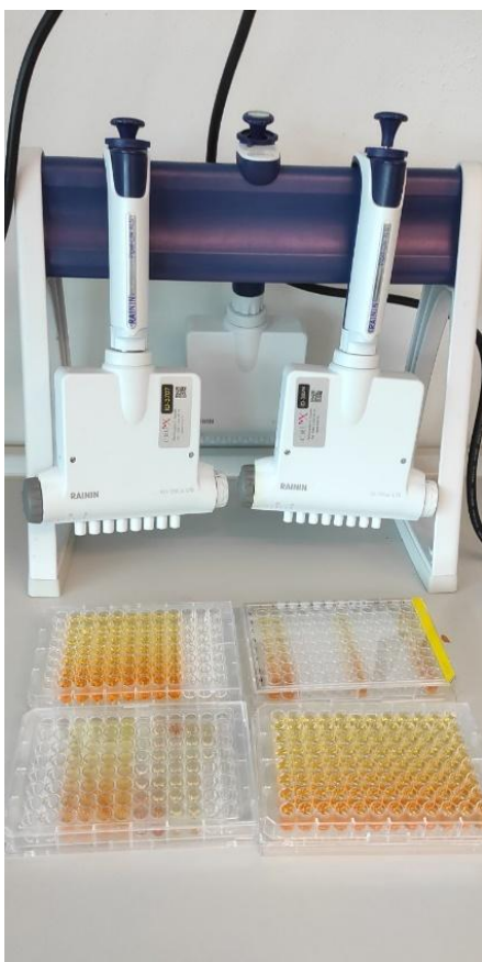
Slika 1. Mikrotitarske pločice sa reakcijskom smjesom za analizu sadržaja prolina
