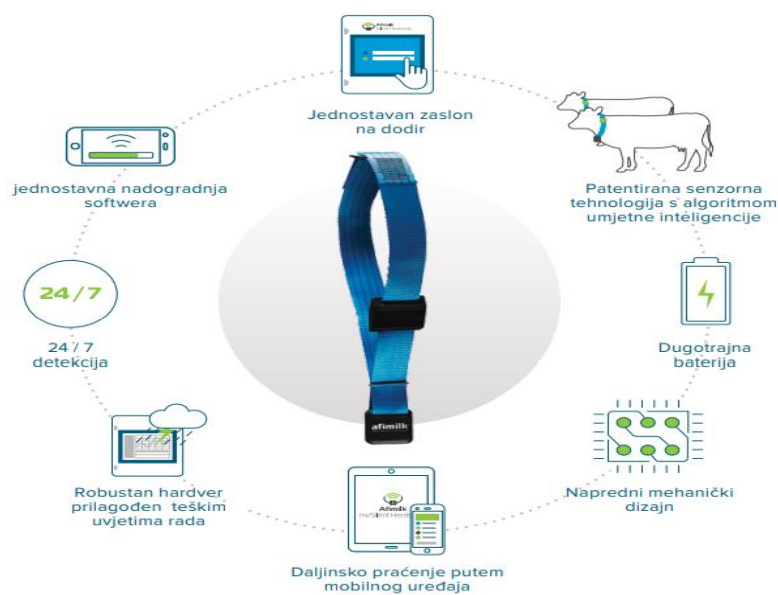
Slika 6. Akcelerometar na ogrlici za krave
