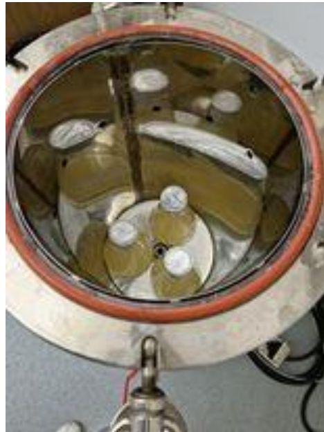
Slika 2. Sterilizacija Erlenmeyerovih tikvica u autoklavu
