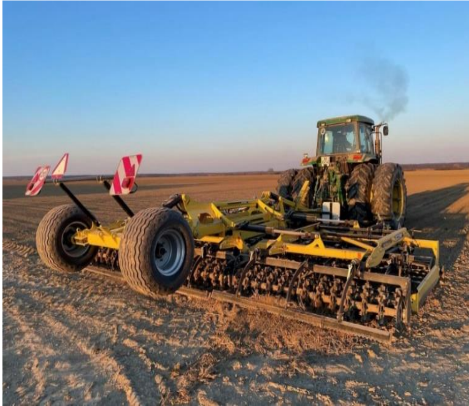
Slika 6. Priprema tla sjetvo spremačem za sjetvu šećerne repe (Ligda, 2022.)
