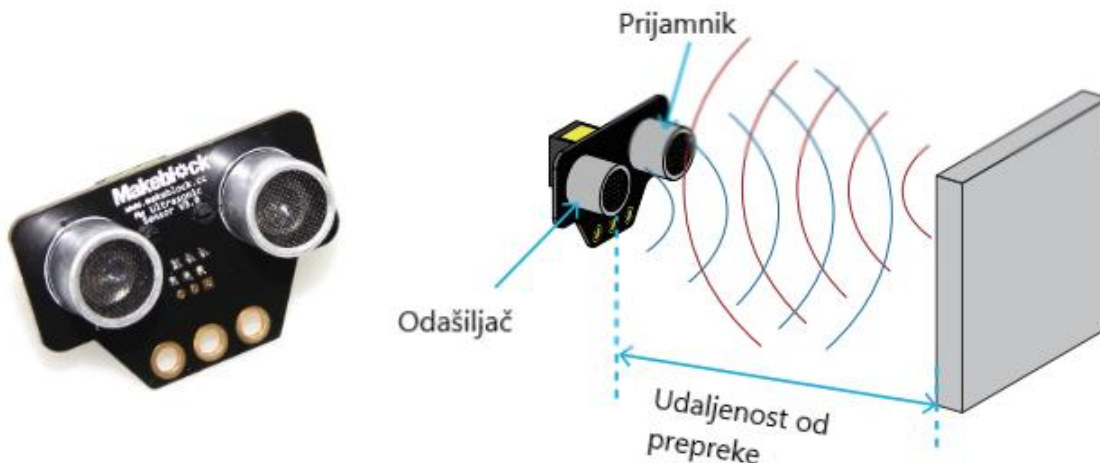
Slika 12. Ultrazvučni senzor (Izvor: https://izradi.croatianmakers.hr/lessons/ultrazvucni-senzor/ )
