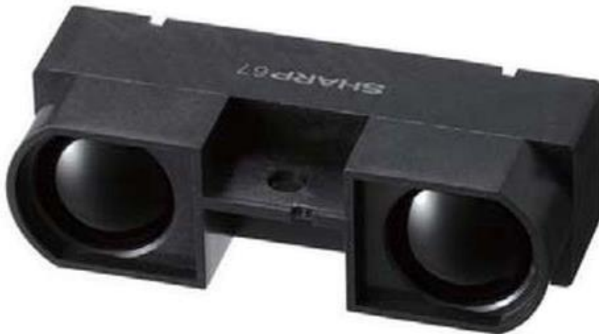
Slika 11. Infracrveni senzor (Izvor: https://www.automatika.rs/baza-znanja/senzori/infracrveni-senzori-daljine.html )
