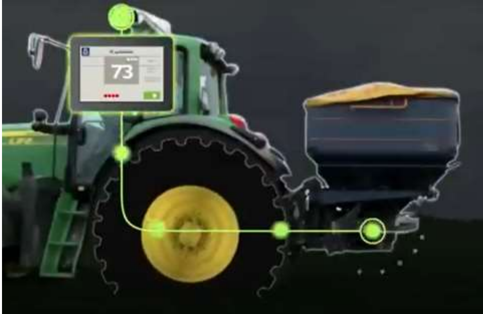
Slika 13. Slanje podataka upravljaču rasipača (YouTube, 2013.)
