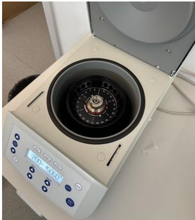
Slika 4. Centrifuga Eppendorf 5425 (Dragomirović, M.)
