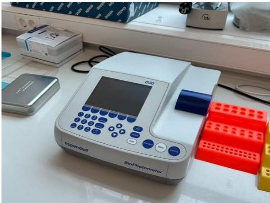
Slika 5. BioPhotometer D30 (Dragomirović, M.)
