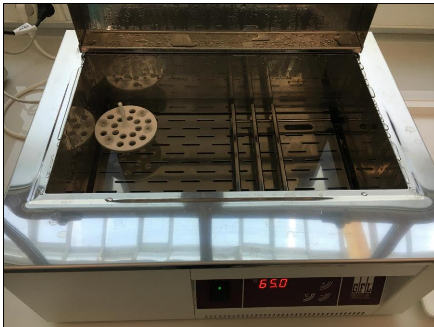
Slika 6. Inkubacija uzoraka u vodenoj kupelji (Dobiš, L.)
