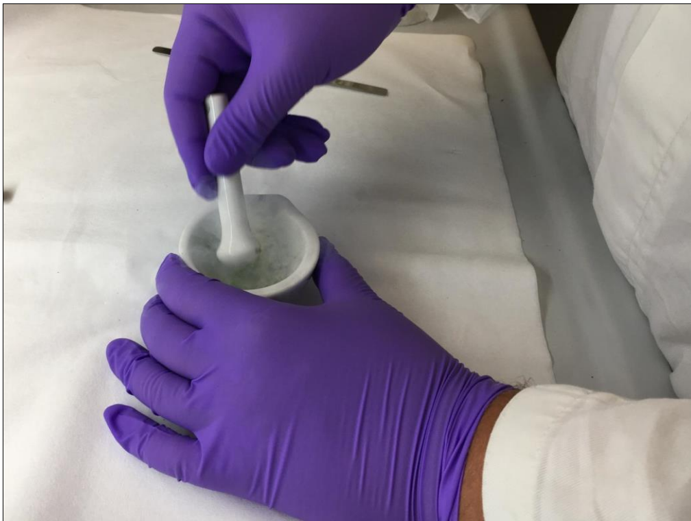
Slika 4. Homogenizacija tkiva pomoću tekućeg dušika (Dobiš, L.)
