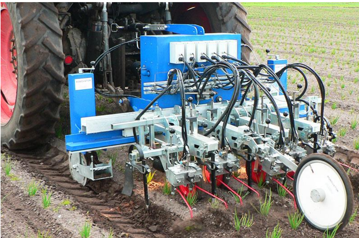
Slika 12. Robovator u povrćarskoj proizvodnji ( Izvor: https://www.visionweeding.com/robovator-mechanical/ )
