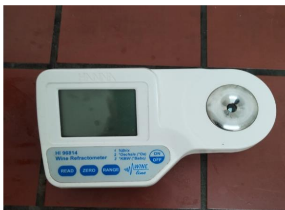
Slika 9. Digitalni refraktometar (Izvor: laboratorij Kutjevo d.d.)
