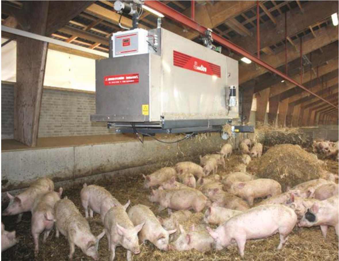
Slika 7. Robotski uređaji za transport i distribuciju slame
