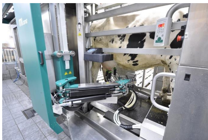
Slika 1. Robotski uređaj za mužnju (Izvor: Rastija, K. (2017.))
