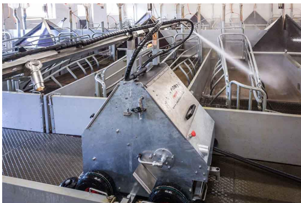
Slika 6. Robot za pranje boksova
