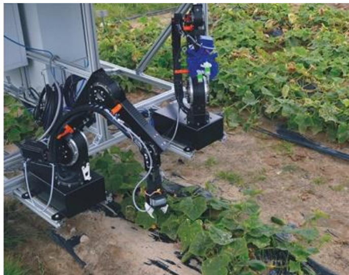
Slika 3. Robot za berbu krastavaca
