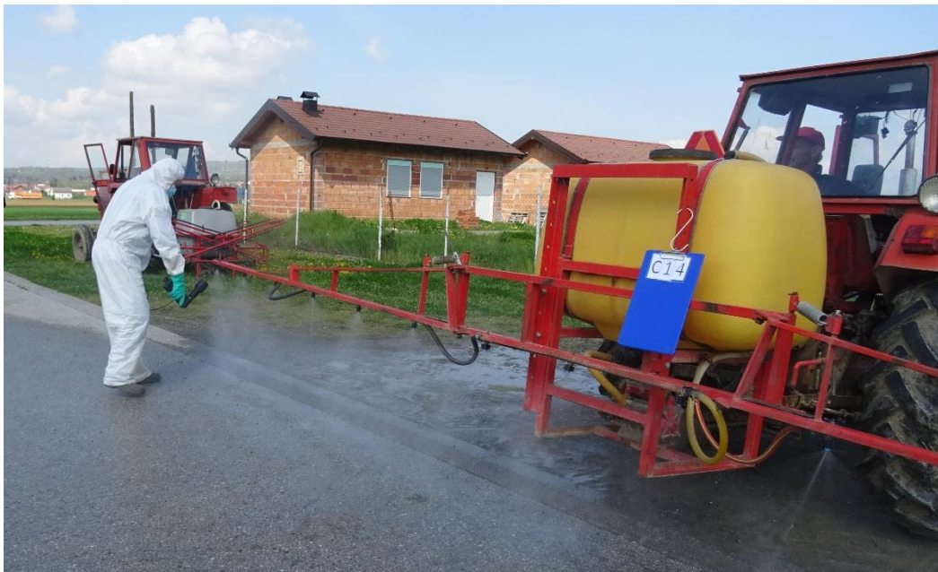
Slika 14. Mjerenje kapaciteta mlaznica
