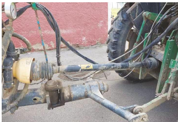
Slika 5. Kardansko vratilo traktora u zaštitnoj plastici
