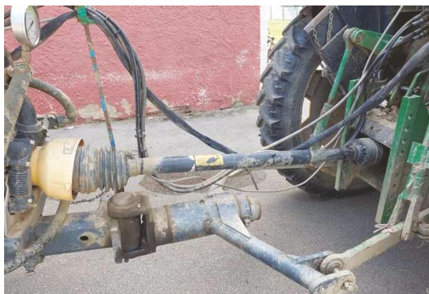
Slika 5. Kardansko vratilo traktora u zaštitnoj plastici
